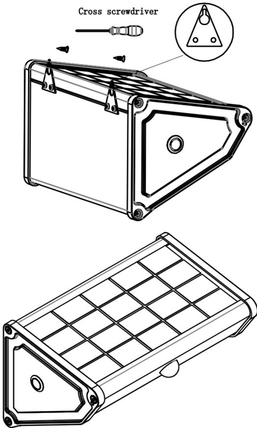
②用十字螺丝刀在墙上的膨胀管上安装两颗自攻螺钉，预留5mm，便于壁灯安装。
